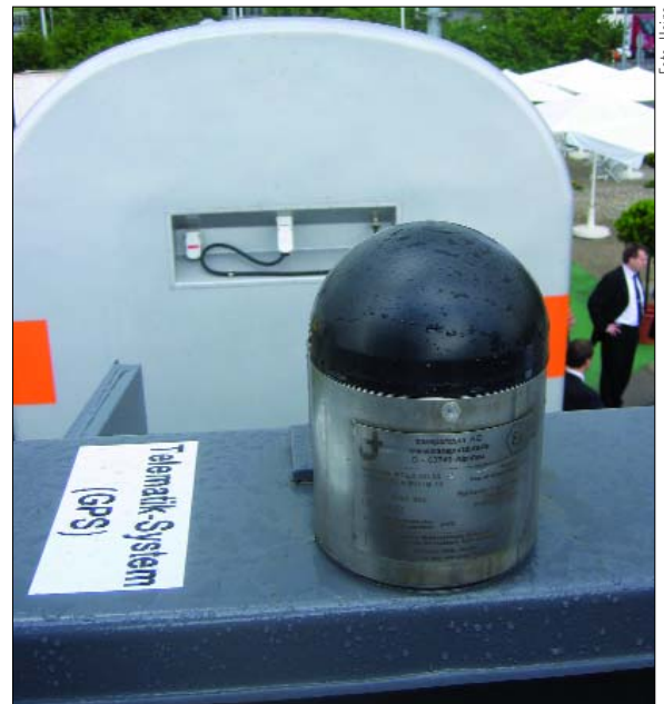
GPS-Sende- und Empfangseinheit auf dem Scheitel eines Bahn-Kesselwagens.
